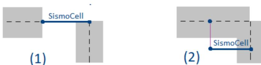
Figura 7: (1) schema esemplificativo della modellazione Tipo 1; (2) schema esemplificativo della modellazione Tipo 2
